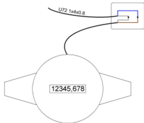
Beim Wasserzähler muss eine Anschlussdose innerhalb **50cm Radius** montiert werden.
