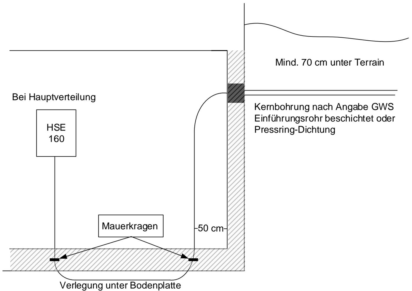
Beispiel Hauseinführung mit Kernbohrung
