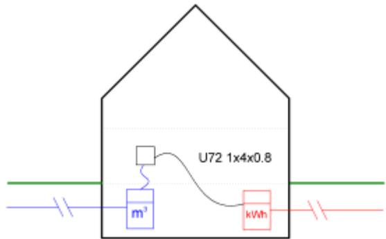
Anschlusschema **mit Aussenzählerkasten**
